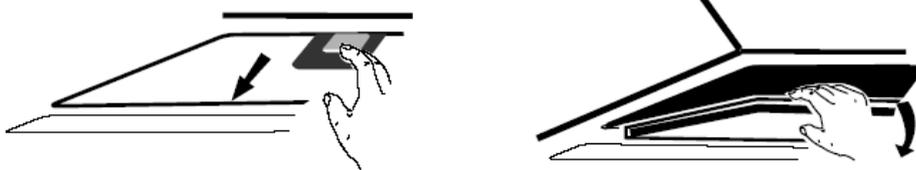
3. Поверните против часовой стрелки угольные фильтры с обеих сторон мотора. Замените их новыми угольными фильтрами.
